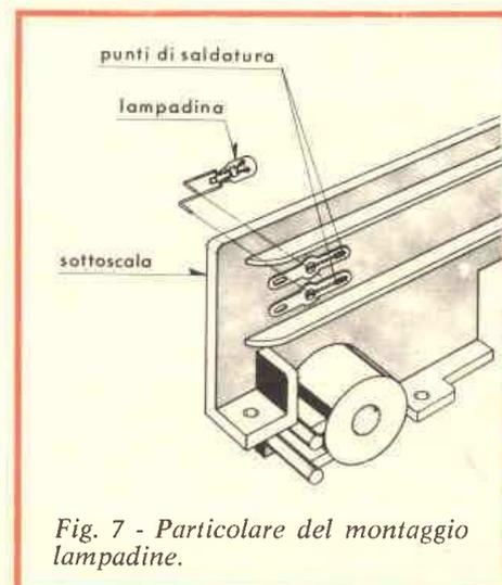
Fig. 7 - Particolare del montaggio lampadine.
